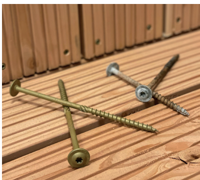
6 MAANDEN IN DOUGLAS HOUT LINKS AR-COATING, RECHTS VERZINKT
